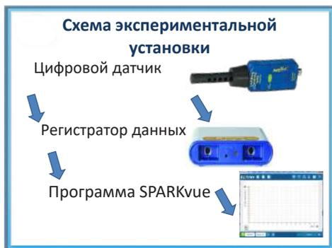
Рисунок 1. Схема экспериментальной установки ЦЛ PASCO
