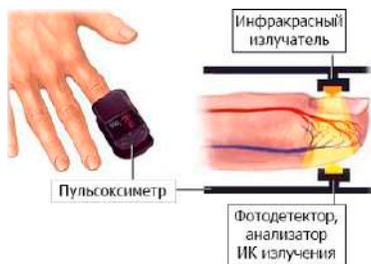
Рис. 2.7. Строение пульсоксиметра
